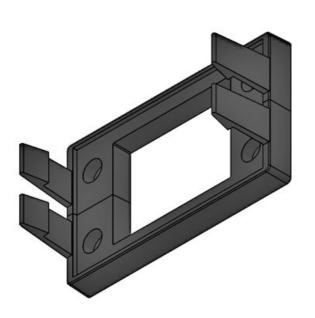
开孔尺寸 订货号 42062 65 × 36 mm 4251269323 螺钉孔的数量 EAN 4 744 螺钉的直径 5,5 mm 包装单位 10 适用于: KEL 10, KEL-长度 108 mm U 10, KEL-FA 10, KEL-宽度 64 mm QUICK 10 38 mm 高度 安装高度 38 mm 可分离 是
