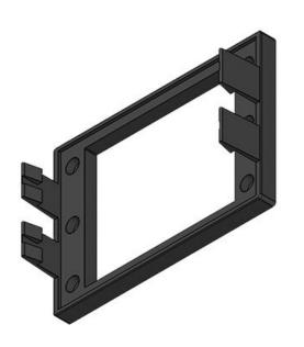
开孔尺寸 订货号 42046 112 × 82 mm 4251269307 螺钉孔的数量 EAN 6 676 螺钉的直径 5,5 mm 包装单位 1 适用于: KEL 24-MT 长度 155 mm 可分离 108 mm 宽度
