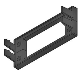
订货号 42060 112 × 46 mm 开孔尺寸 4251269323 螺钉孔的数量 EAN 4 720 螺钉的直径 5,5 mm 包装单位 10 适用于: KEL 24, KEL-长度 155 mm U 24, KEL-宽度 64 mm QUICK 24, 高度 38 mm KEL-FA 24, 安装高度 38 mm KEL-FG-A 是
