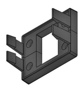
订货号 42063 开孔尺寸 38 × 46 mm EAN 4251269323 螺钉孔的数量 4 751 螺钉的直径 5,5 mm 包装单位 10 适用于: KEL-B, KEL-U-B, KEL-长度 81 mm QUICK-B 64 mm 宽度 38 mm 是 高度 可分离 安装高度 38 mm
