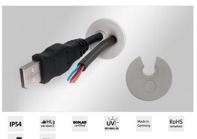
Les KEL-QTE sont des plaques passe-câbles divisibles qui se clipsent directement sur une tôle de 1.5 à 2.5 mm d'épaisseur. Le système KEL-QTE permet d'introduire des câbles pré confectionnés et non pré confectionnés.
